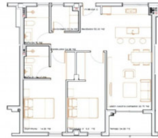
Plano de planta con distribución de muebles y decoración de interiores. Escala: 1:100. Fuente: Proyecto de Arquitectura.
